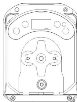
Fig. 14- Enlèvement du tuyau péristaltique
